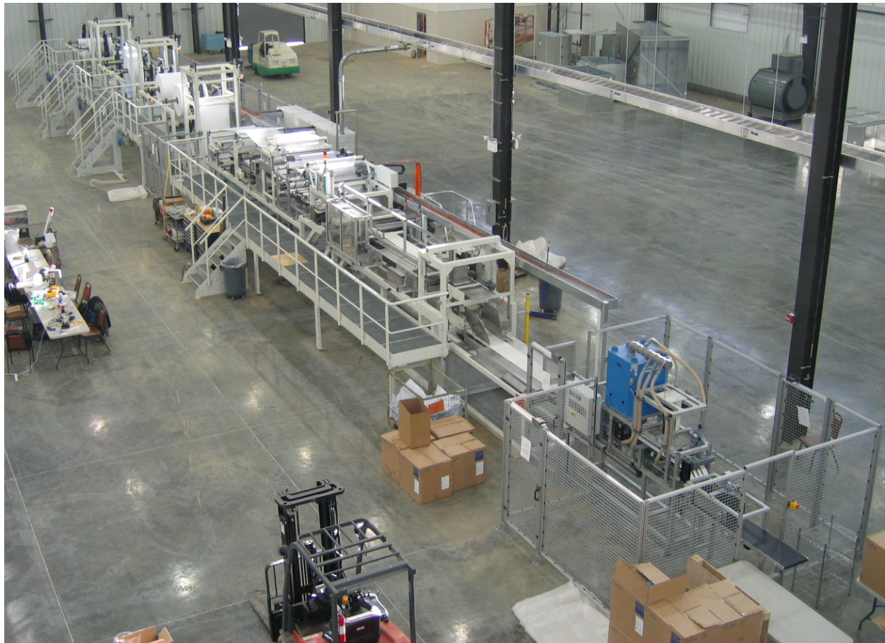
Wickel-, Verbund- und Falzmaschine zur Herstellung von Krankenunterlagen
